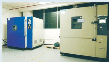
低气压测试箱(左), 恒温恒湿测试箱(右)
